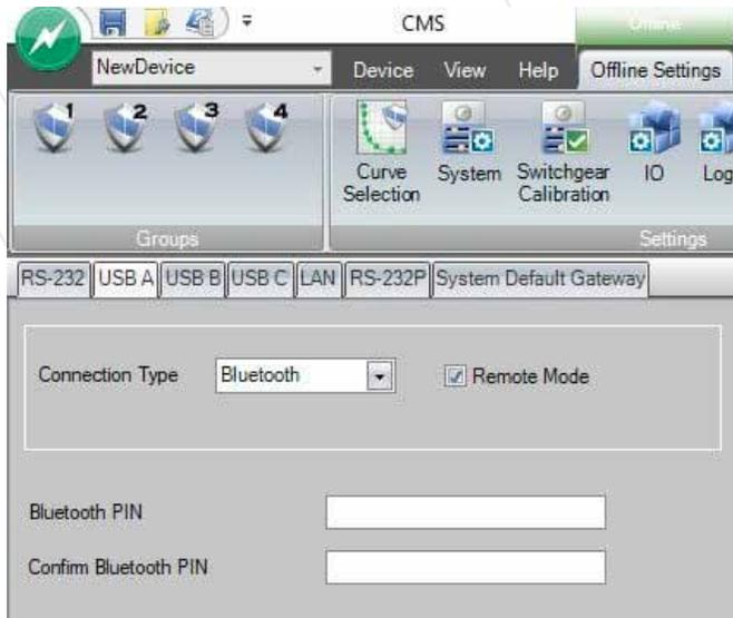
Los usuarios deben conectarse al control mediante el software CMS de NOJA Power para poder habilitar el puerto USB y la comunicación vía Bluetooth. En ese momento se debe asignar un PIN de acceso al puerto. Este PIN será necesario para establecer comunicación desde cualquier dispositivo que intente conectarse con el equipo.
