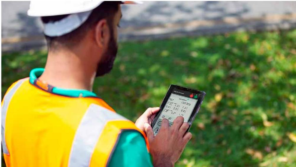
La aplicación HMI Remoto de NOJA Power ofrece mayor seguridad para los operadores en campo, ya que reproduce la pantalla del control del reconnector de NOJA Power en un dispositivo, ya sea celular o Tablet, a través de una conexión inalámbrica segura.
