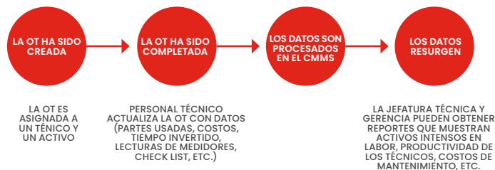
Fig. 7 – Proceso que sigue un sistema CMMS a partir de una orden de trabajo (OT) asignada.
