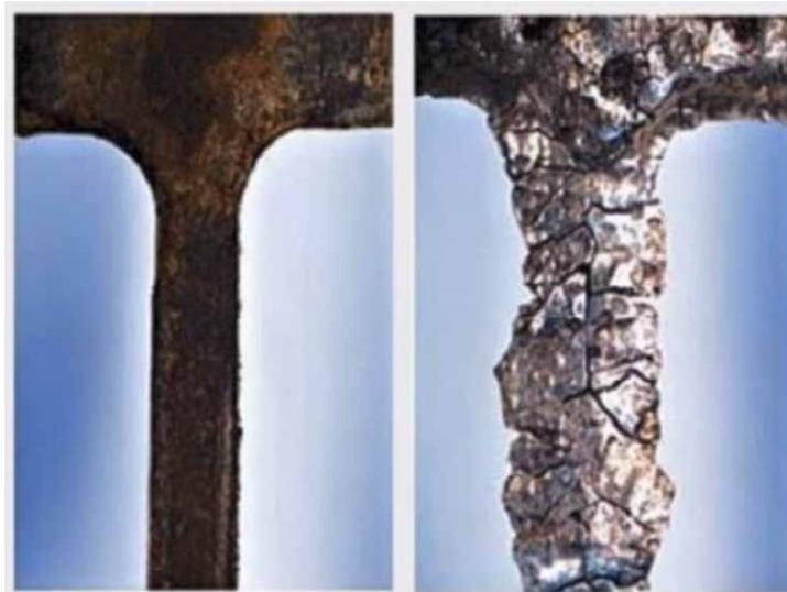
Figura 2. Corrosión en placas de una celda de Plomo-Ácido
